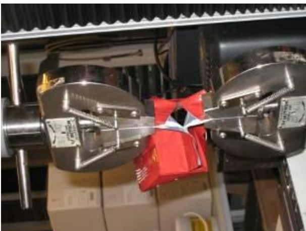
Figur 2 Mekanisk måling af trækstyrken ved adskillelse af vingerne i folieposen
