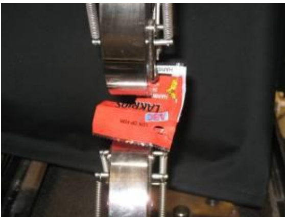
Figur 2 Mekanisk måling af rivestyrken af slikposen med pre-cut.
