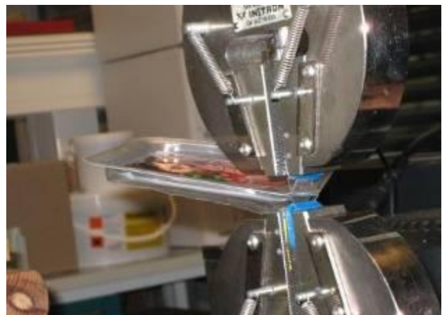
Figur 2 Mekanisk måling af trækstyrken for åbning af pålægsbakke med fleksibelt topfolie og easy-peel (adskillelse af over og underfilm).
