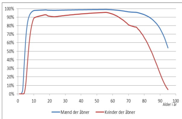
Figur 4 Andelen af mænd og kvinder der kan åbne den termoformede pålægsbakke med påsvejset låg ved brug af snipper (2X2 cm 2 trekant) åbningskraften er på 17,5 N (Model baseret på data fra DTI, UK 2002).
