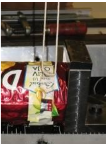
Figur 2 Mekanisk måling af trækstyrken af tear-snip i kikserullen.
